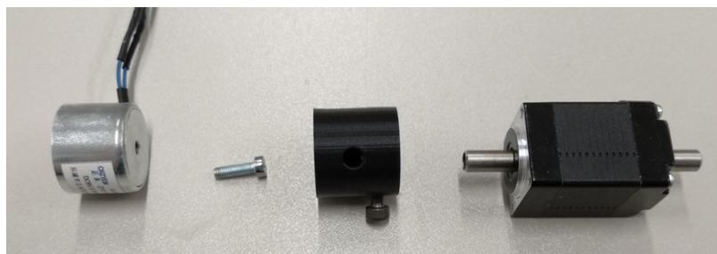
Abbildung 5.3: Elektromagnet, Verbindungsstück und Schrittmotor
