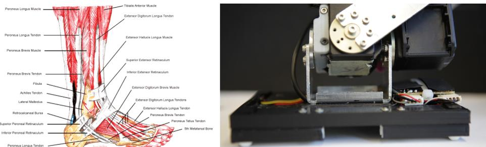
**Abbildung 2.2:** Fuß eines Menschen (links) [Swierzewski, 2017] und Fuß eines Roboters (rechts). Während der Roboterfuß aufgrund der beiden Motoren nur über zwei Freiheitsgrade verfügt, besteht der menschliche Fuß neben den Knochen aus vielen Sehnen und Muskeln, die zu vielen Freiheitsgraden führen.
