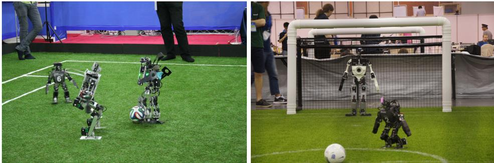
**Abbildung 1.2:** Links: Minibot (Mitte) beim Versuch über den Rasen zu laufen, was ein trippelndes, instabiles Schlittern ist. Rechts: Hambot (hinten) unbeweglich im Tor, da bisher kein funktionierender Laufalgorithmus existiert.
