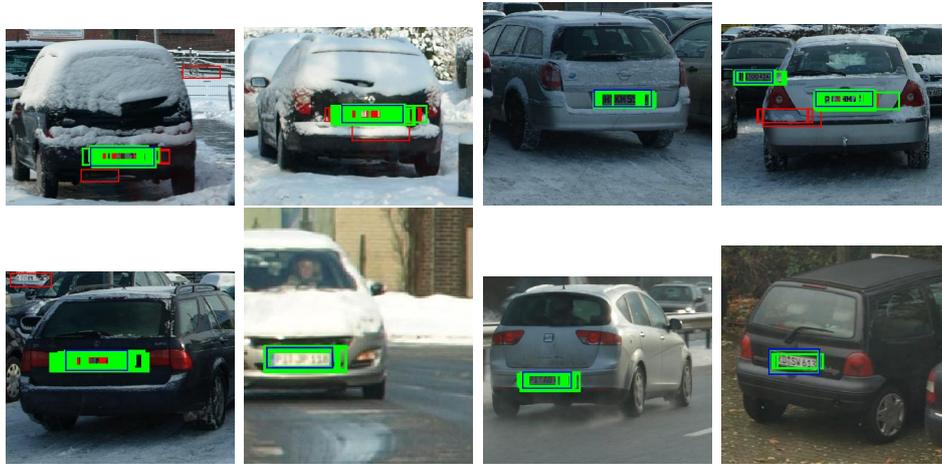
Abbildung A.4: Ergebnisbilder der Kaskade "HF3081 Preboost ME03 K1971 VJ", 37 Bilder, Detektionsrate 0.81, Falsch-Positive 201.
