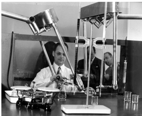
Abbildung 1.1: Ein früherer Telemanipulator in der Nuklear-Forschung.
