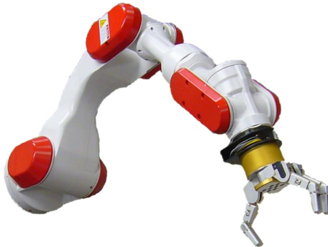
Abbildung 2.2: Manipulator mit Greifer als Endeffektor.
