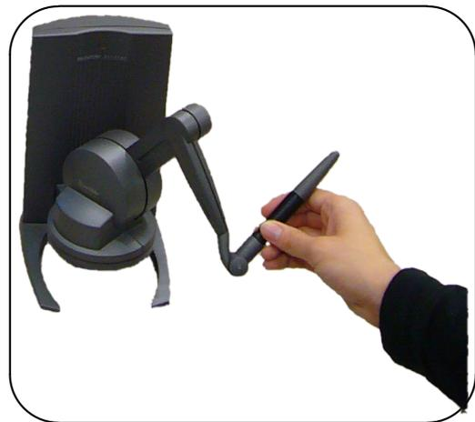
Abbildung 4.2: PHANTOM Desktop, ein haptisches Eingabegerät.
