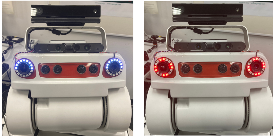
Abbildung 15: Zustandsvisualisierung des PR2-Roboters mithilfe von NeoPixel-Ringen und einem Visualisierungskonzept, das sich auf Emotionen und Gesichtsausdrücke stützt.
