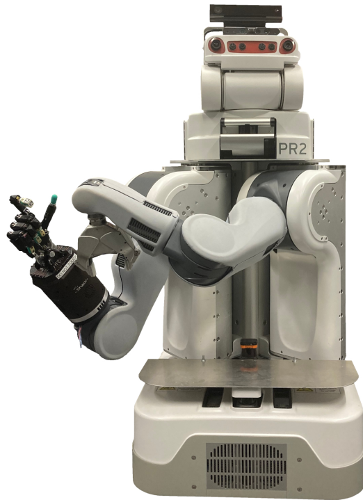
Abbildung 1: Der PR2 ist aktuell einer der fortschrittlichsten Forschungsroboter. Seine leistungsstarken Hard- und Softwaresysteme ermöglichen es ihm, Tische aufzuräumen, Handtücher zu falten und Getränke aus dem Kühlschrank zu holen. Der PR2-Roboter der Forschungsgruppe TAMS trägt zudem an seinem rechten Arm die sogenannte Shadow Dexterous Hand der Firma The Shadow Robot Company und auf seinem Kopf eine Microsoft Xbox One Kinect-Sensorleiste.
