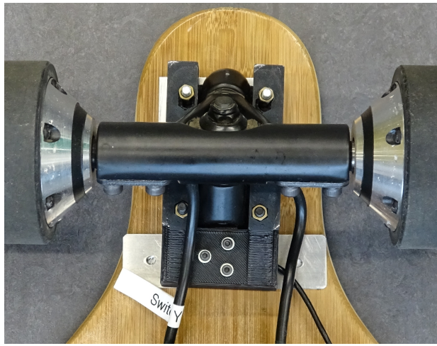
(b) Sensorhalterung, montiert
