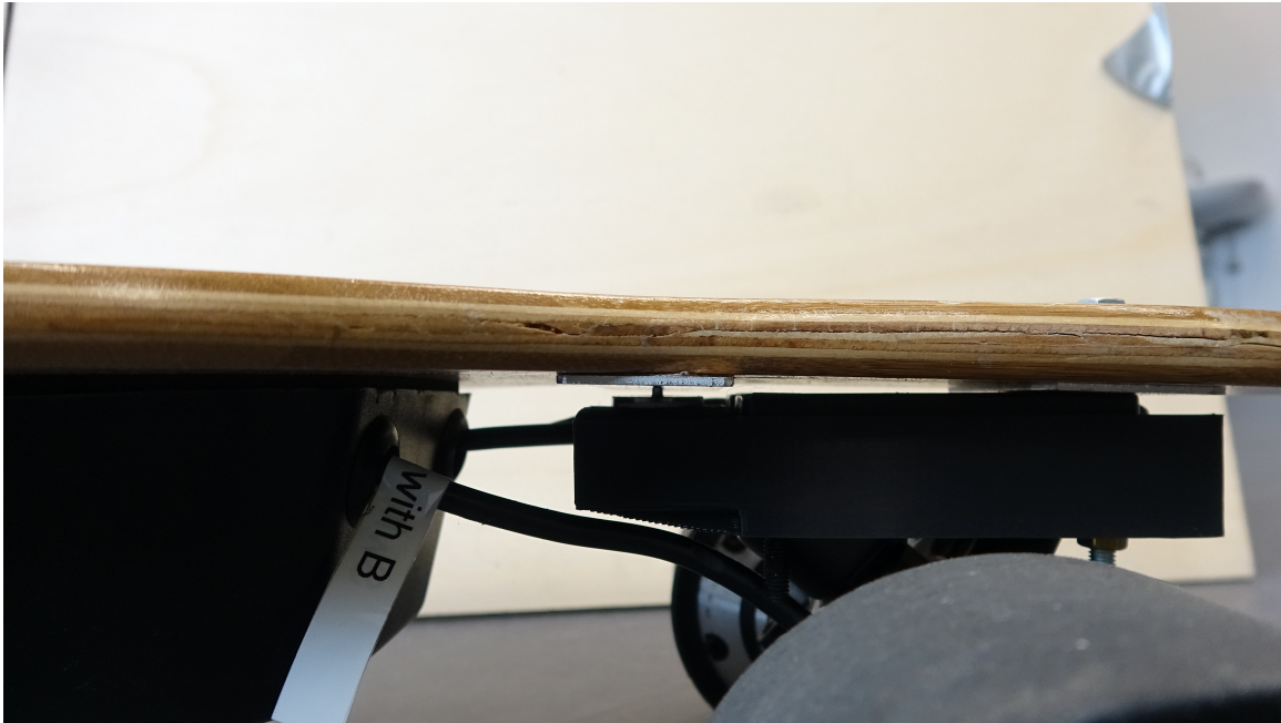
Abbildung 3.3: Seitliche Ansicht der montierten Sensorhalterung.
