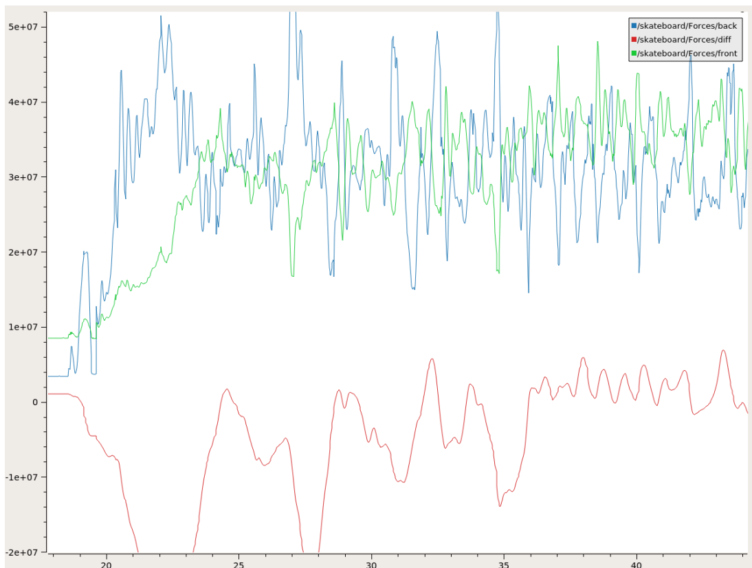
Abbildung 5.5: Sensordaten während der Fahrt mit der trivialen Konfiguration mit einer Testperson mit einem Gewicht von 101 Kg. Differenzwert in Rot, Frontsensor in Grün, Hecksensor in Blau.
