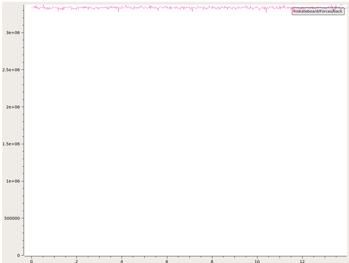
Abbildung 4.4: Rauschen bei Stromversorgung durch USB-Akku.
