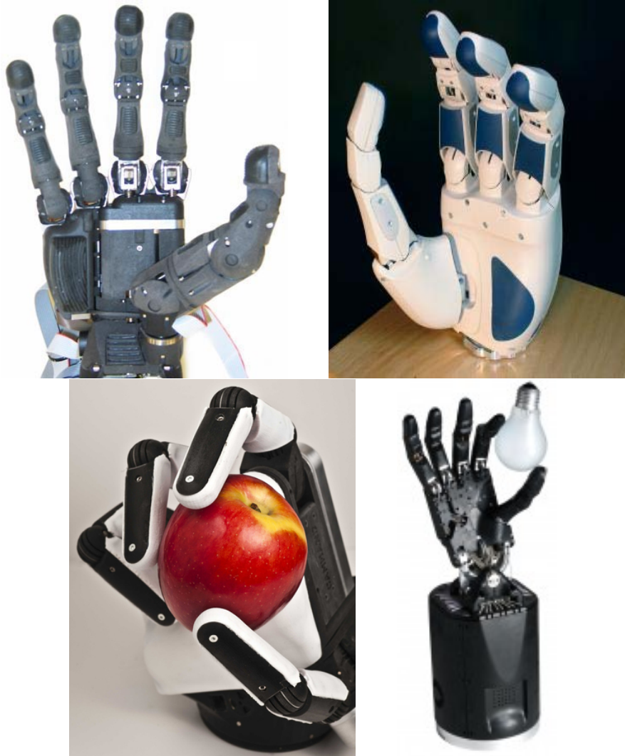
Abbildung 2.5: Dargestellt sind von oben links nach unten rechts die ELU-1 Hand, DLR-Hit Hand I, Sandia Hand und die Shadow Dexterous Hand C6M. Abbildung entnommen aus ELU-1 Hand [2010] , DLR Hand [2014] , Sandia Hand [2012] , Shadow [2009] .
