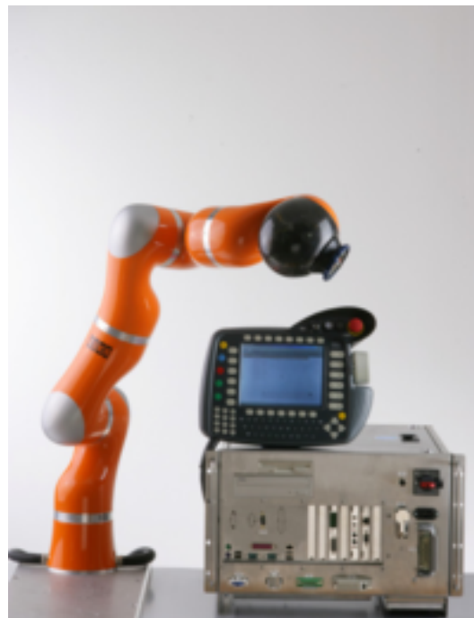
Abbildung 3.3: Abgebildet ist der KUKA Lightweight Robot (LWR) mit dem KUKA Robot Controller und dem KUKA Control Panel (KCP). Abbildung entnommen aus Bischoff [2010] .
