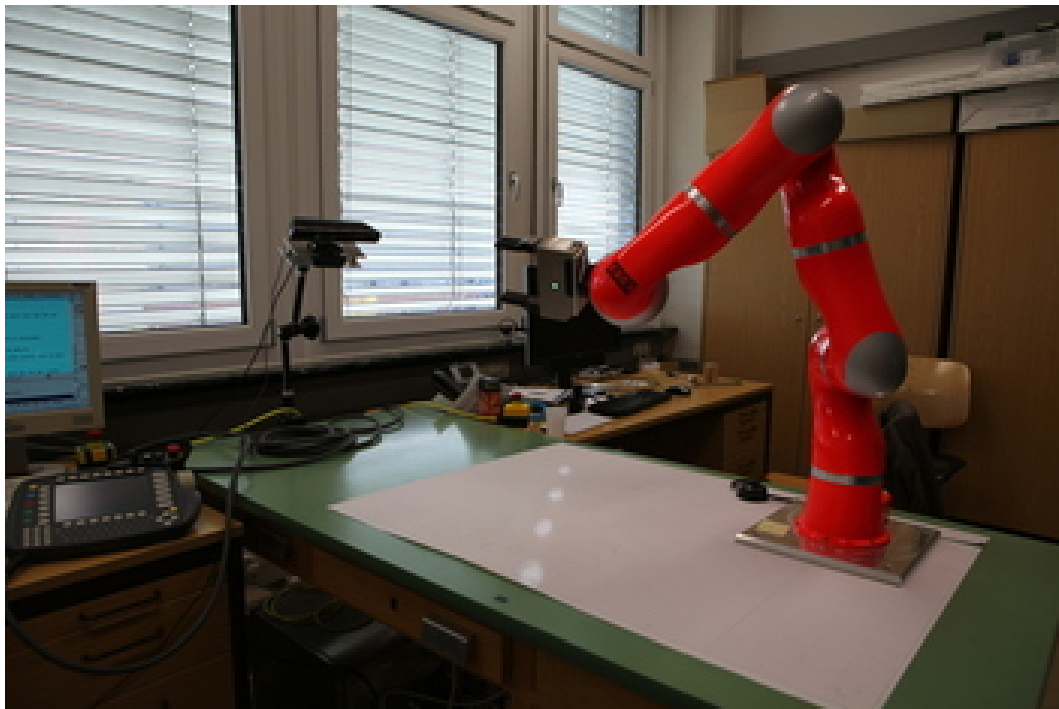
Abbildung 3.1: Dargestellt ist der KUKA LWR, Weiss Robotics WSG 50 & WSG-DSA, Microsoft Kinect und die Logitech HD Pro Webcam C910. Letztere befindet sich unter der Microsoft Kinect.
