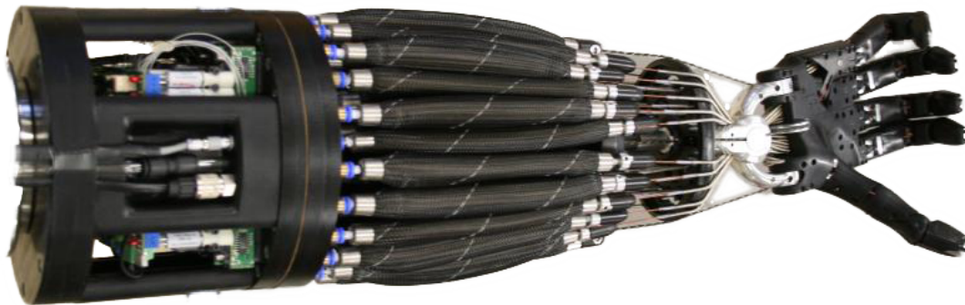
Abbildung 3.3: Die Shadow Dextrous Hand mit dem Unterarm mit pneumatischen Muskeln und der Steuerungselektronik mit den Ventilen
