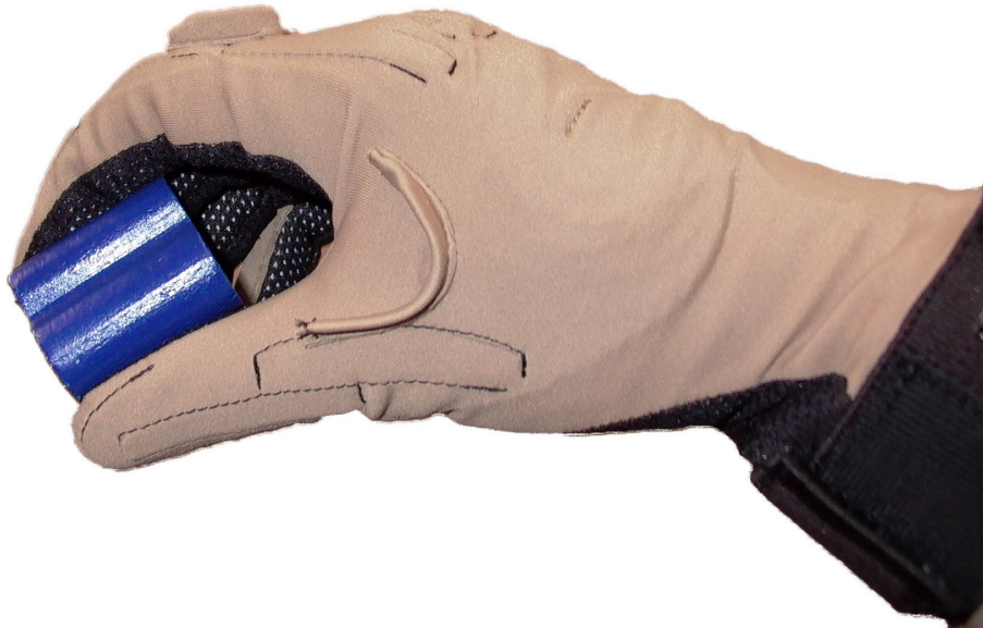
Abbildung 3.7: Der CyberGlove bei einem Experiment. Am Daumen sind die eingenähten Sensoren gut erkennbar
