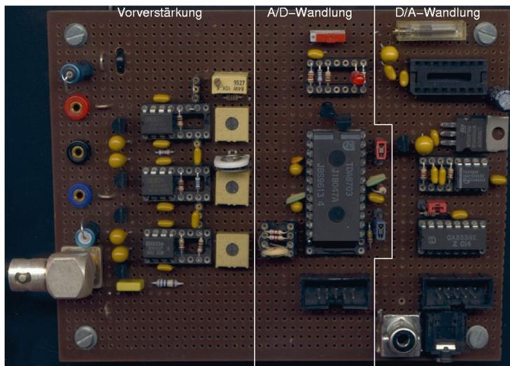
Abbildung B.2: Analogverstärker, AD- und DA-Wandler
