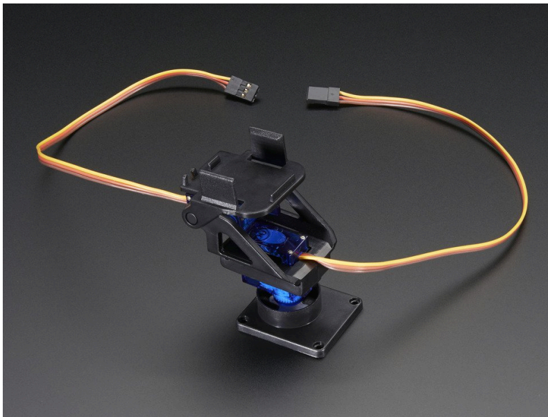
Abbildung 4: Mini Pan-Tilt Unit (PTU) basierend auf zwei Servo-Motoren.
