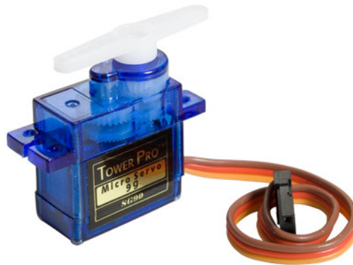
Abbildung 2: Micro-Servo mit einem Arbeitsbereich von 180 Grad.
