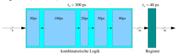
*Pipelining:* Gegeben sei die oben gezeigte Funktionseinheit. Die Zeitangabe  $t_d=300\,\mathrm{ps}$  sagt aus, dass die Reaktion auf einen Signalwechsel am Eingang des kombinatorischen Logikblockes nach 300 ps am Ausgang erscheint (= Verzögerungszeit der Funktion). Für das Register soll der Einfachheit halber lediglich eine Zeitbedingung eingeführt werden: die Zeitdauer zwischen Taktvorderflanke und Ausgabe des neuen Werts am Datenausgang sei  $t_d=40\,\mathrm{ps}$ .
