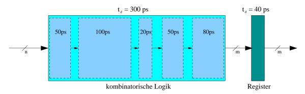
**2.2.7.1 [10]:** Gegeben sei oben gezeigte Funktionseinheit. Die Zeitangabe  $t_d=300ps$  sagt aus, dass die Reaktion auf einen Signalwechsel am Eingang des kombinatorischen Logikblockes nach 300ps am Ausgang erscheint. Man könnte auch formulieren, dass eine Operation 300ps benötigt. Für das Register soll der Einfachheit halber lediglich eine Zeitbedingung eingeführt werden. Die Angabe  $t_d=40ps$  soll hier bedeuten, dass das Register 40ps benötigt, um den Eingabewert zu verarbeiten.
