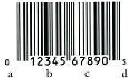
*Figure 2—UPC-A bar code*
