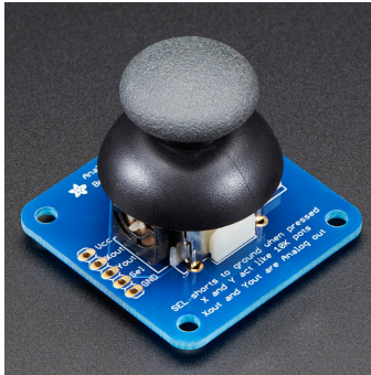
Abbildung 2: 2-Achsen Joystick basierend auf zwei Drehpotentiometern.
