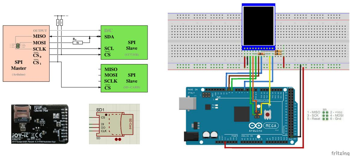
Abbildung 1: Vorschlag für die Verdrahtung des Versuchsaufbaus. Bitte **ergänzen** Sie die Verdrahtung des SD-Slots der Abbildung oben links **und** vergessen Sie beim Hardwareaufbau ebenfalls nicht, den auf dem Displayboard integrierten SD-Slot anzuschließen.
