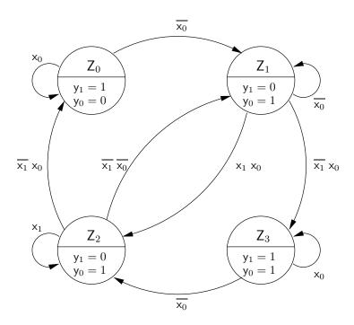
(a) Ermitteln Sie aus dem Zustandsdiagramm die zugehörigen Gleichungen für die Übergangsfunktion  $\delta$  zur Berechnung des Folgezustands  $Z^+$  aus aktuellem Zustand Z und den Eingabewerten X.
