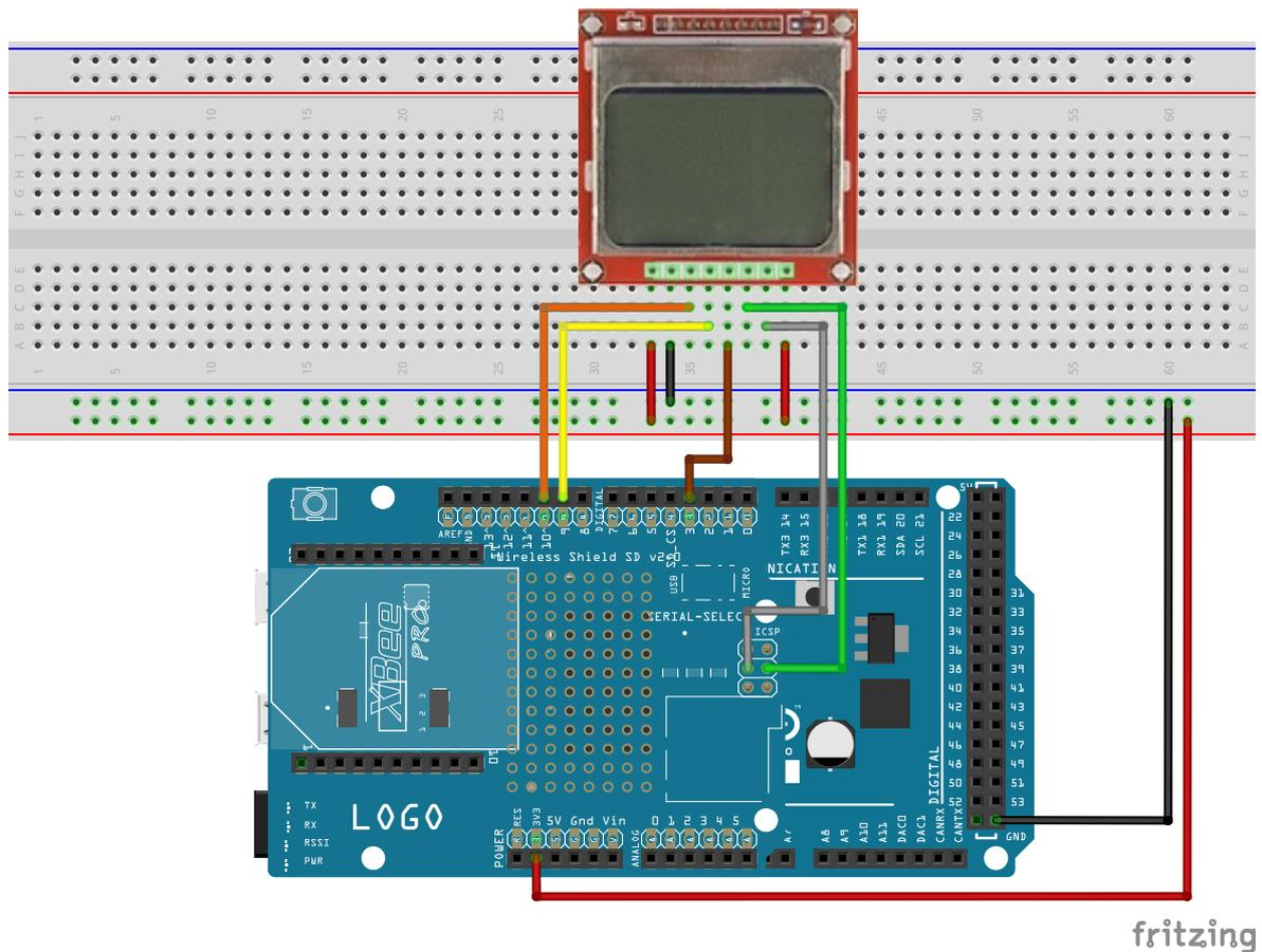
Abbildung 2: Vorschlag für die Verdrahtung des Versuchsaufbaus.
