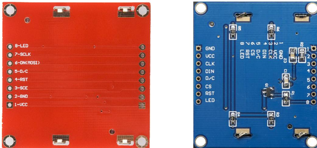
Abbildung 1: Anschlusspins beider Versionen der LC-Display Platinen.
