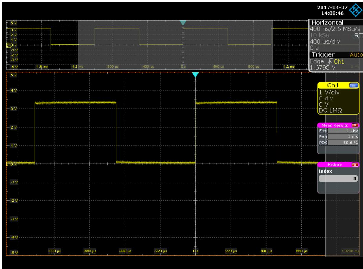
Abbildung 2: Pulsweitenmoduliertes Signal (@ 1 kHz).
