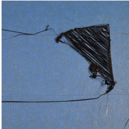
**Abbildung 4:** Filament löst sich vom Druckbett
