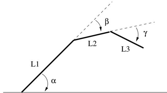
mit  $L1 = 1 \text{ m}$ ,  $L2 = L3 = 0,5 \text{ m}$ ,  $\alpha = \gamma = 45^\circ$ ,  $\beta = 30^\circ$ .
