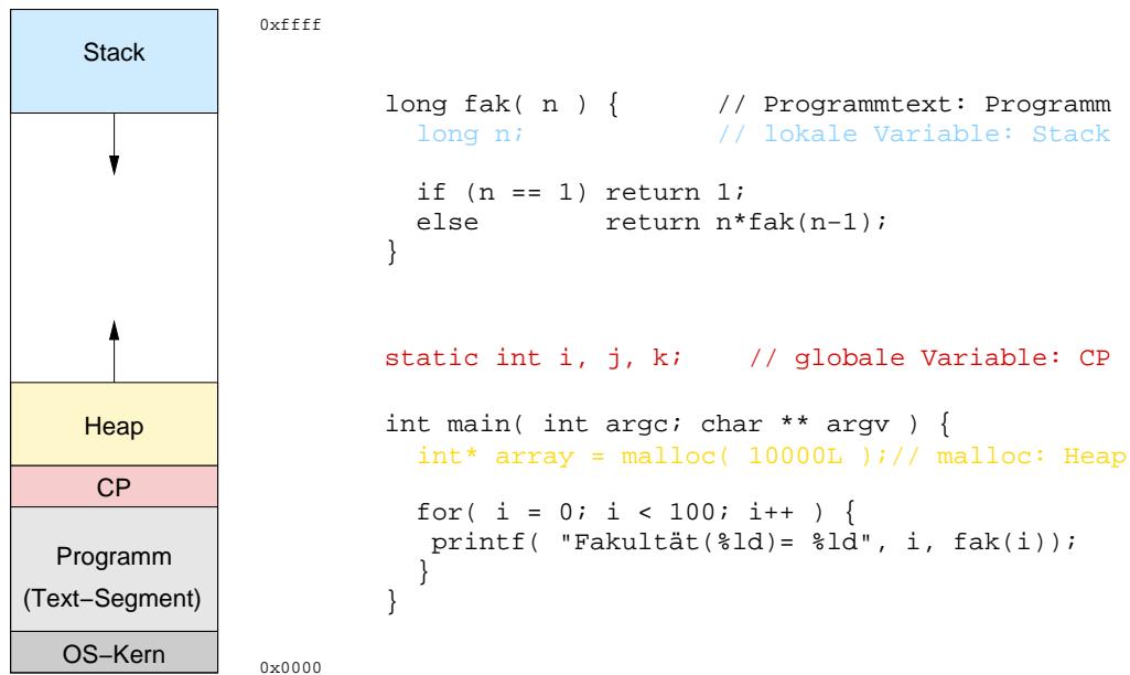
Abbildung 2: Speicherbereiche im Hauptspeicher: Textsegment, Konstantenpool, Heap, Stack
