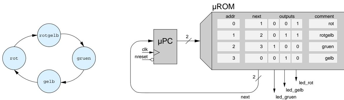
Abbildung 2: Prinzip der Mikroprogrammierung: einfacher Automat (links) und Realisierung mit linearem Mikroprogramm
