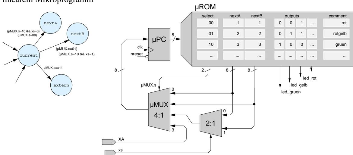
Abbildung 3: Mikroprogrammiertes Steuerwerk mit zwei externen Eingängen xs und XA und vierfacher Auswahl des Folgezustands (siehe Text).
