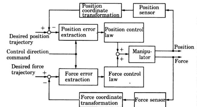
Zwei Rückkopplungsschleife für separate Regelung von Position und Kraft.
