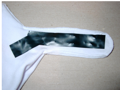
Zusätzlichen Schutz vor ungewollter Kontaktierung und vor Abriss bietet das Klebeband.
