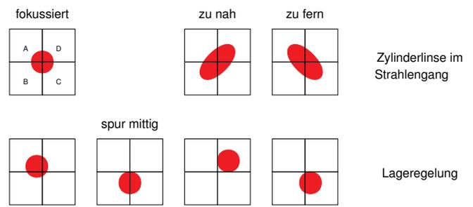
Sensorfeld mit 2x2 Photodioden zur Regelung:
